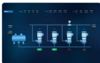
泵站运行监控
